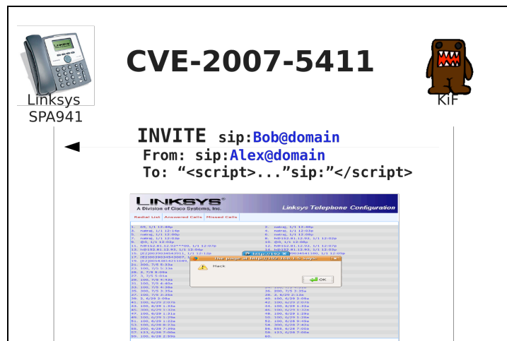
Figure 2 : Attaque XSS contre un équipement Linksys SPA-941
