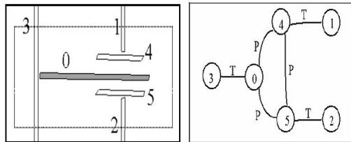
FIG. 4 – Représentation sous forme de graphe d'une forme [33]
