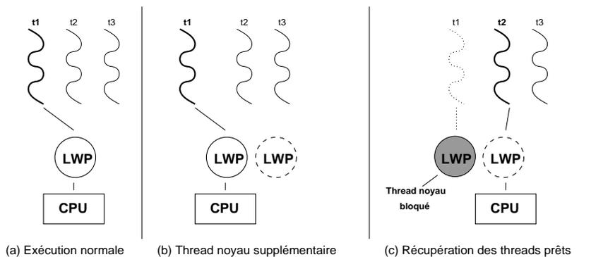
FIG. 1 – Utilisation d'un thread noyau (LWP) supplémentaire pour permettre un appel bloquant.
