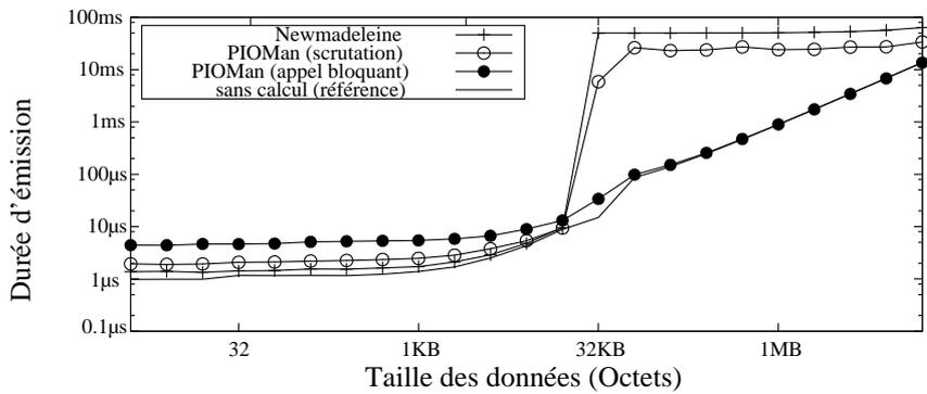
FIG. 3 – Temps d'émission mesurés pour MX/Myrinet.
