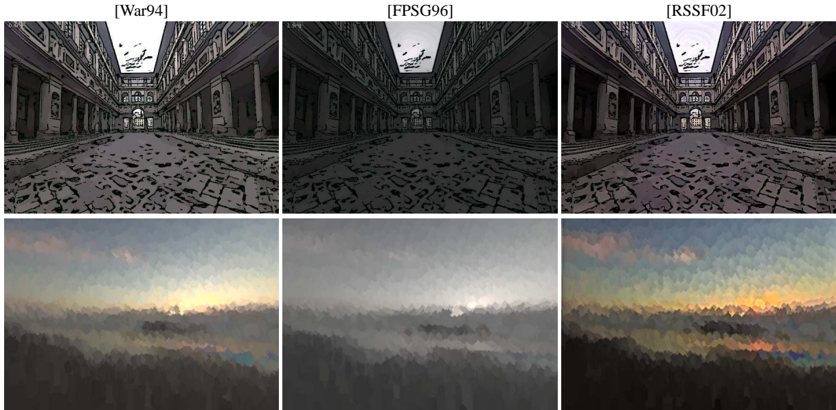
FIG. 5: Comparaison de quelques opérateurs d'adaptation de ton sur un style cartoon (en haut) et sur un style impressionniste (en bas). La même calibration, sans mise à l'échelle, a été utilisée pour toutes les images.
