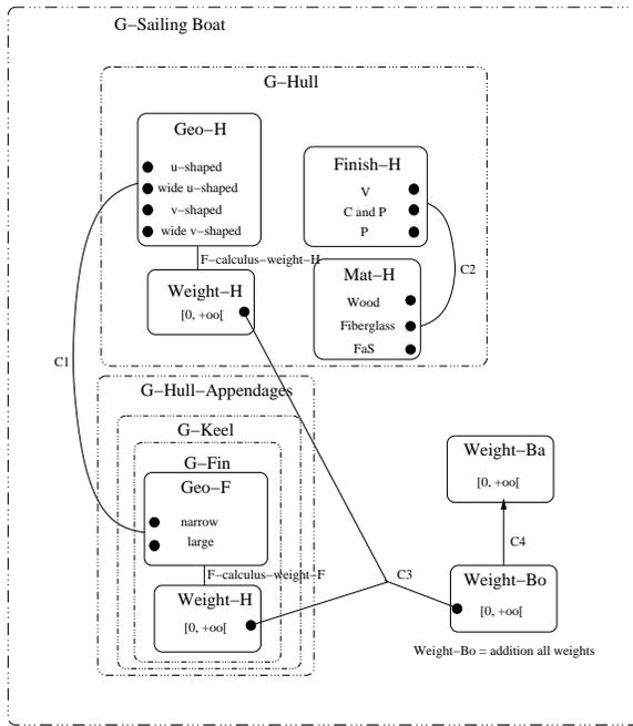
FIG. 2: Modèle CSP du bateau à voile
