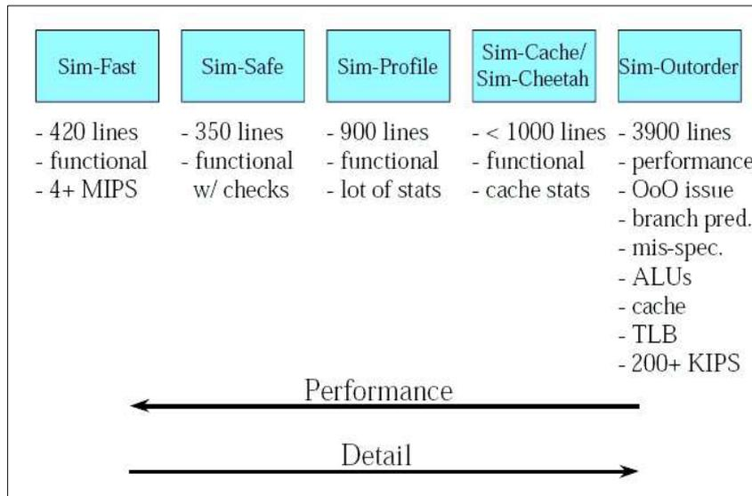
**Fig. 14 :** Les simulateurs de *SimpleScalar* d'après [Austin97]
