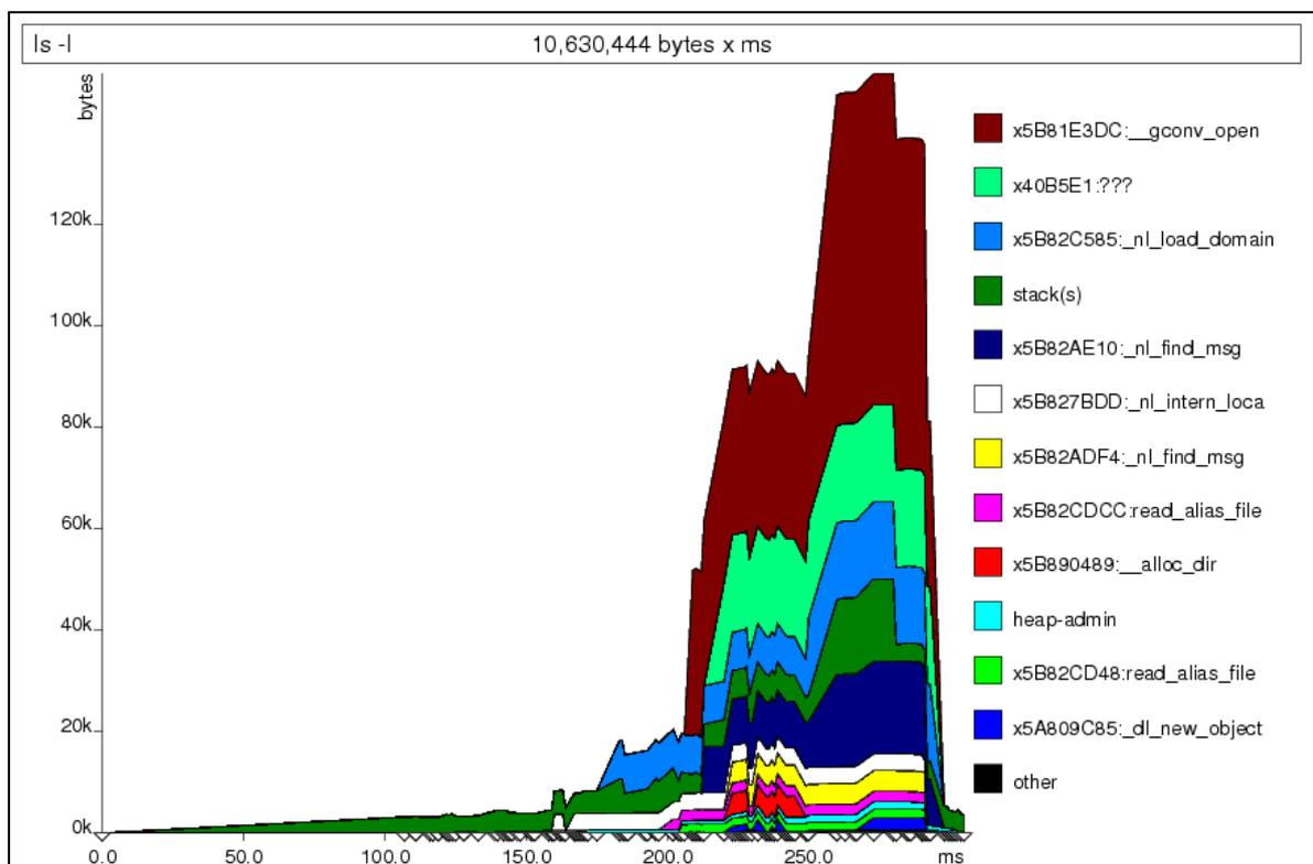
**Fig. 4 : Profil mémoire de la commande *ls-l***
