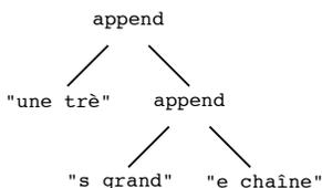
est l'une des multiples façons de représenter la chaîne "une très grande chaîne". Une corde peut donc être directement codée par le type Ocaml suivant :
