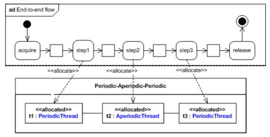
Figure 21. MARTE model, periodic-aperiodic-periodic case.
