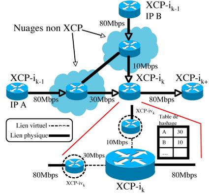
FIG. 3 – Routeur XCP-*i* avec un routeur virtuel par nuage non-XCP.
