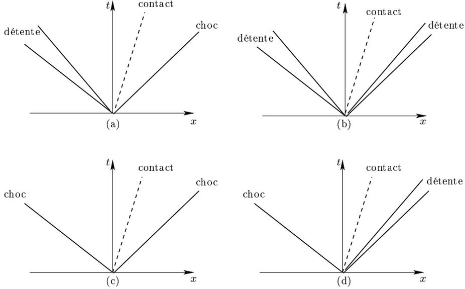
FIG. 3 – Configurations possibles des ondes dans la solution du problème de Riemann
