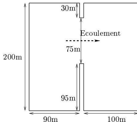
FIG. 5 – Rupture partielle de barrage : Géométrie du bassin
