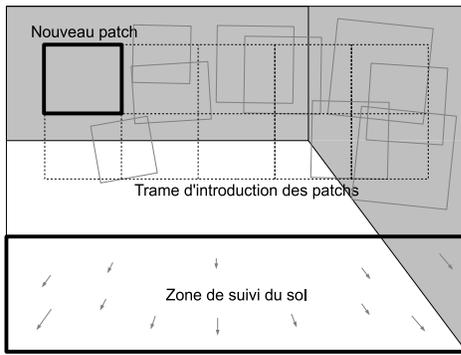
FIG. 5 – Zones utilisées pour la segmentation automatique.
