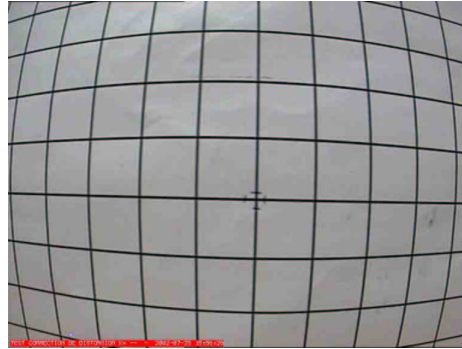
FIG. 3.5 – Effets de la distorsion sur une grille de test orthogonale
