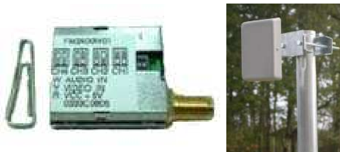
FIG. 7.3 – Emetteur 100mW et nouvelle antenne
