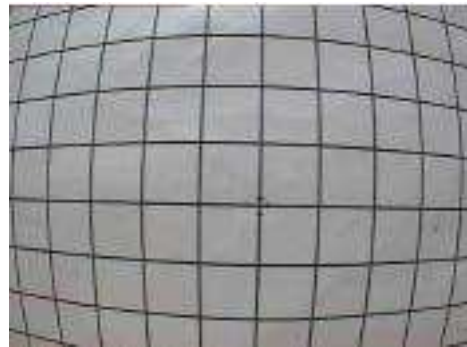
FIG. 4.4 – Distorsion sur une mire
