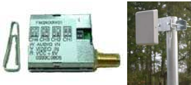
FIG. 7.3 – Emetteur 100mW et nouvelle antenne
