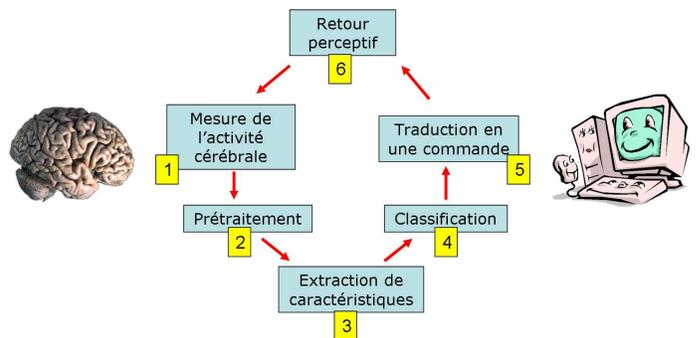
Fig. 1. Schéma général de fonctionnement d'une interface cerveau-ordinateur.
