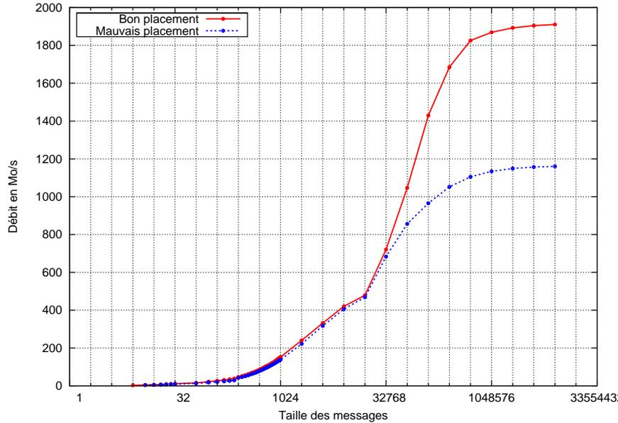
FIG. 1.4 – Débit observé lors d’un ping-pong multirails sur les réseaux MYRI-10G et QSNET.
