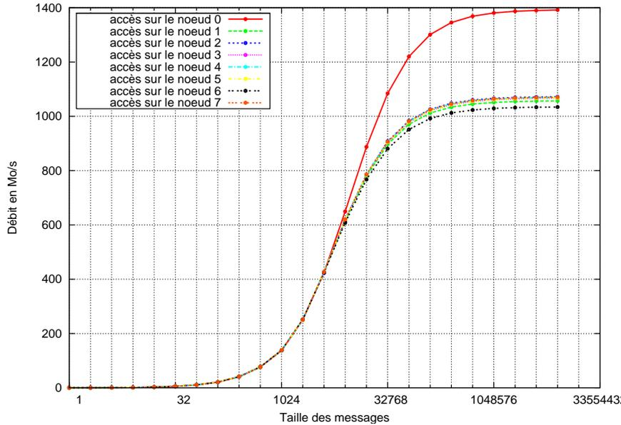
FIG. 2.8 – Variation de débit lors d'écritures RDMA sur les différents nœuds de la machine NUMA 8 nœuds *Hagrid*, sur le réseau INFINIBAND.
