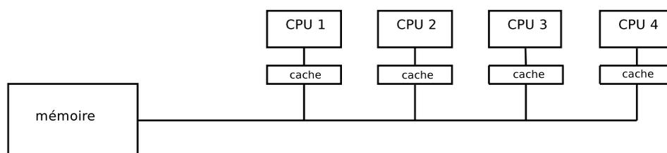
FIG. 1.1 – Machine SMP à quatre processeurs.
