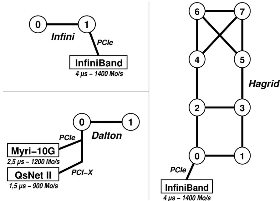
FIG. 2.2 – Architectures NUMA des machines de la plateforme de test.
