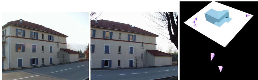
FIG. 1 – Deux images d’une scène et une reconstruction 3D obtenue à partir de six images au total. Les pyramides représentent les positions reconstruites et le champ de vue des caméras utilisées.
