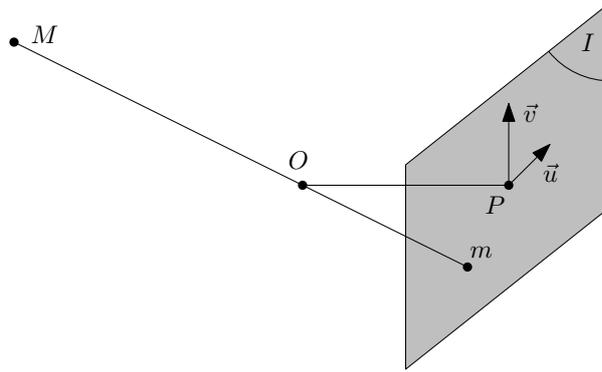
FIG. 5 – Projection perspective d'un point 3D.
