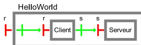
Fig. 3.2 – Assemblage Fractal correspondant à l'ADL de la figure 3.3.
