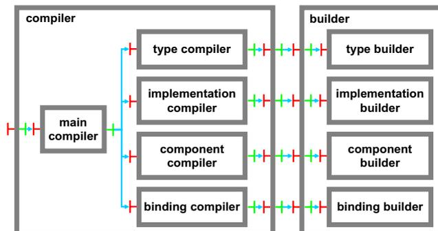
Fig. 3.13 – Architecture des composants *compiler* et *builder*.
