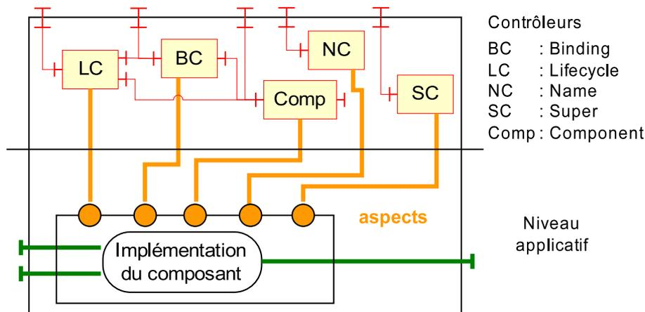
Fig. 3.10 – Membrane de contrôle pour les composants primitifs.
