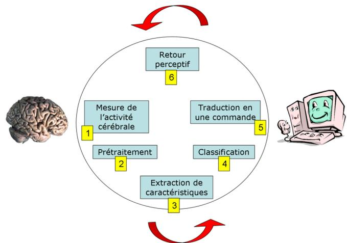
FIG. 1: Schéma général de fonctionnement d'une interface cerveau-ordinateur.
