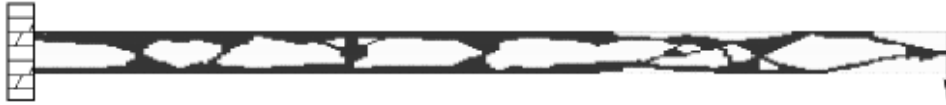
FIG. 16 – Structure optimale sur le maillage 200 \times 20 pour le cantilever 10 \times 1 . D_{lim}=12 , D_{max}=11.99 , poids=0.445. Temps CPU = 28s/génération.
