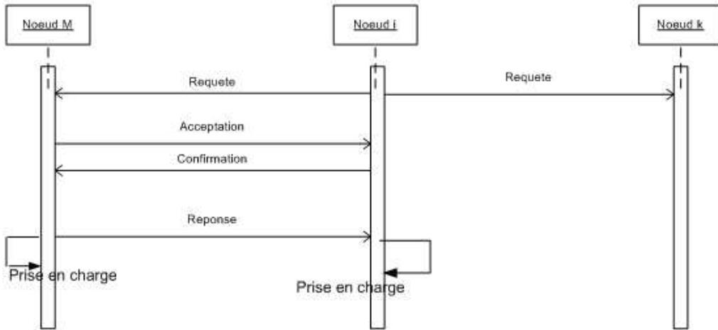
Figure 2: Exemple de négociation et d'obtention d'un supporteur
