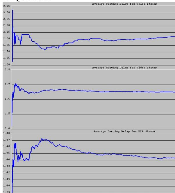
**Fig. 4.2. Temps moyen d'attente avec (m,k)-WFQ (1<sup>er</sup> scénario)**
