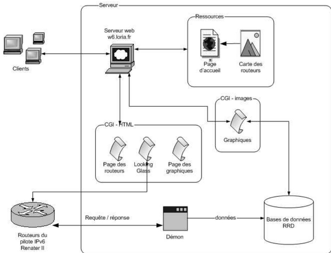
fig 7 : Architecture du site de supervision avant modification
