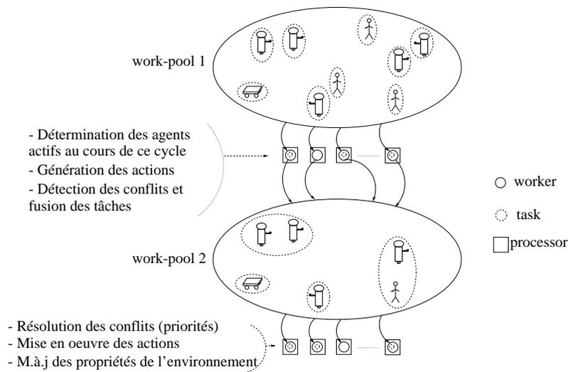
FIG. 1 – Simulation parallèle utilisant deux work-pools
