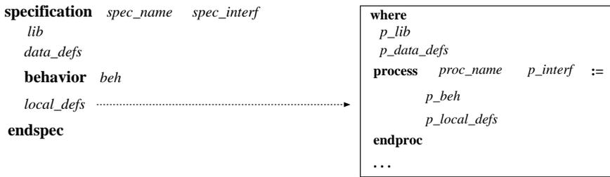
Des opérateurs de développement peuvent être appliqués pour aider à définir ces variables. Ils travaillent en parallèle sur le plan de travail et sur le méta-programme, réduisant une tâche et faisant évoluer le produit associé. Ils permettent de construire directement ou par réutilisation soit des types abstraits de données soit des expressions de comportement en termes d'algèbres de processus.
