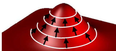
FIG. 10 – Exemple d'isoursurface en rouge avec les gradients (flèches noires) montrant l'évolution du champs scalaire.
