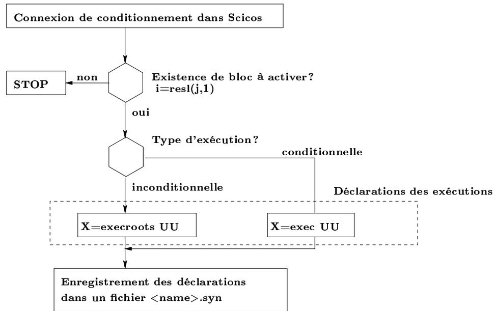
FIG. 3.9 – Déclaration des exécutions en SynDEx : fonction scu43.
