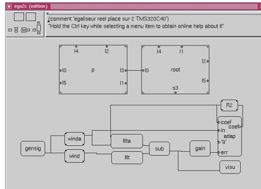
FIG. 3.1 – La représentation d'un diagramme dans l'éditeur SynDEX.
