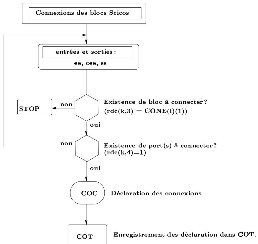
FIG. 3.8 – Déclaration des inter-connexions en SynDEx : fonction *scv42*.
