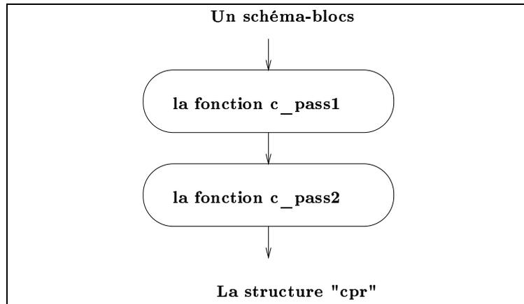
FIG. 1.19 – Les étapes de compilation d'un schéma bloc
