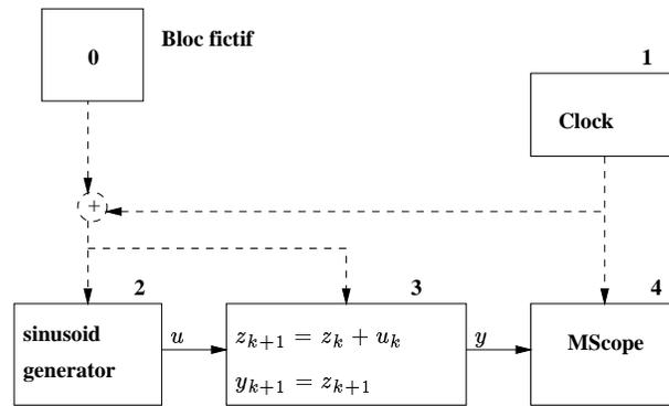
FIG. 1.12 – Le conditionnement de la figure 1.11.
