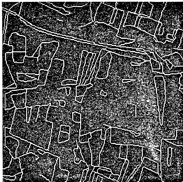
Figure 3 : Restauration des contours incomplets - Période fixe = 2 - Nombre d'itérations = 1 - Algorithme de l'échantillonneur de Gibbs
