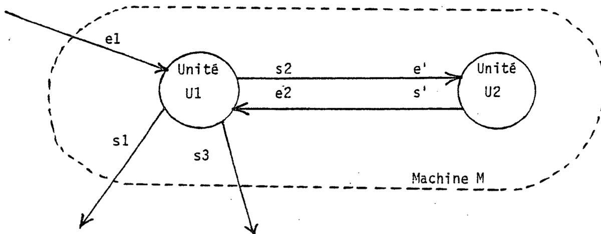
Ces graphes de connexion sont réalisés sous la forme d'automates d'états finis que nous appelons automates de transition et qui déterminent le champ des transitions valides entre unités d'une même machine.
