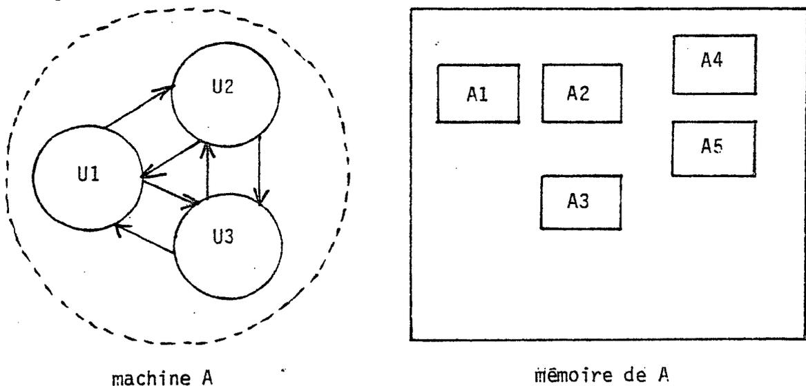
Soit donc la machine A dont la mémoire est constituée des objets créés ou préexistants sur cette machine, soient A1, A2, A3, A4 et A5.
