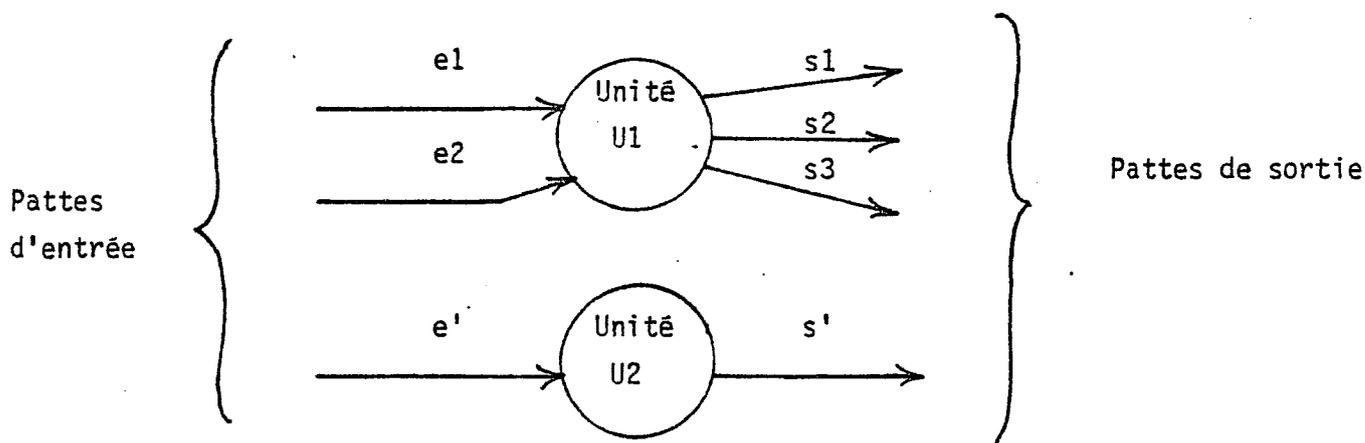
Les unités qui composent une machine sont connectées entre elles en associant des pattes de sortie avec des pattes d'entrée d'unités différentes selon un certain graphe de connexion défini de manière statique. Au moment du RENVOI effectué par une unité, l'acheminement du message est déterminé par le graphe de connexion suivi.
