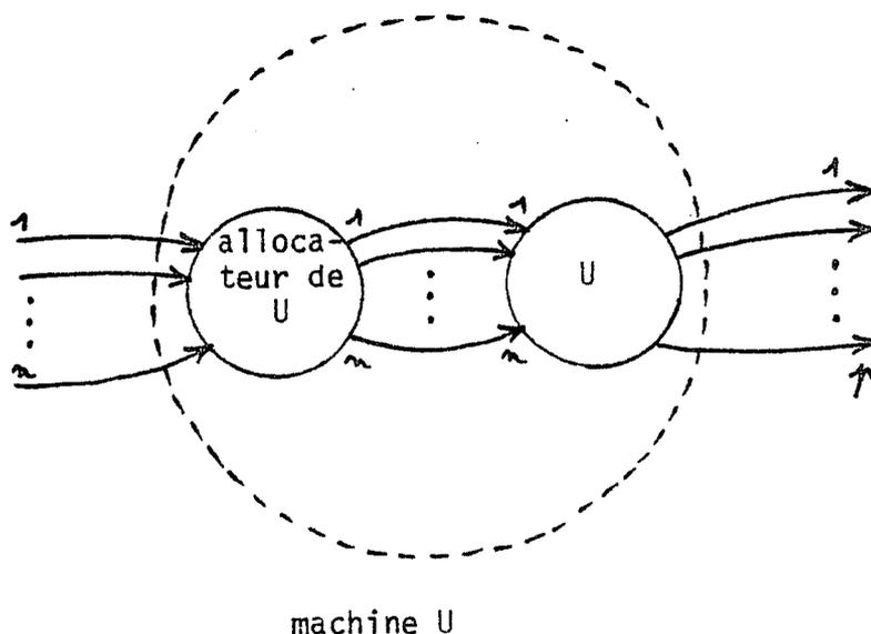
L'allocateur de U est l'unité d'entrée de la machine U; les pattes d'entrée et de sortie de la machine U sont les mêmes que celles de l'unité U.
