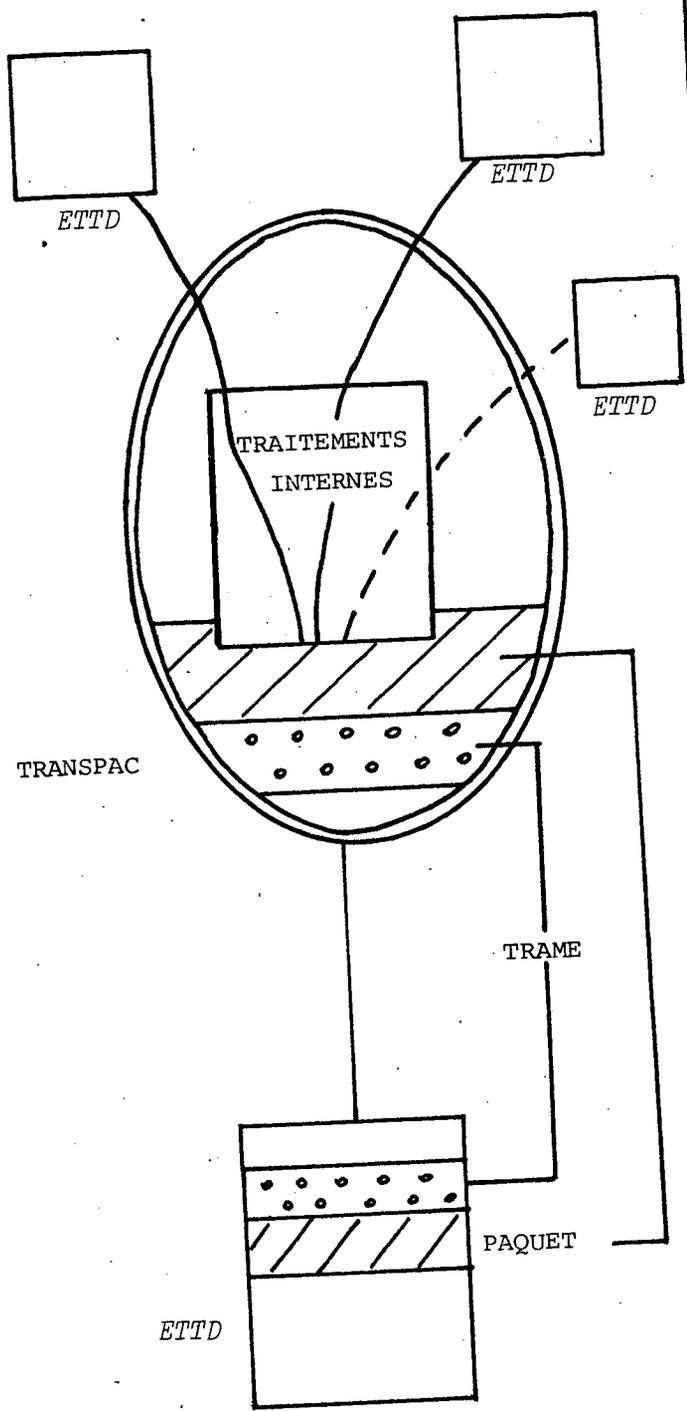
Figure II.5. - Différents niveaux des circuits virtuels.
