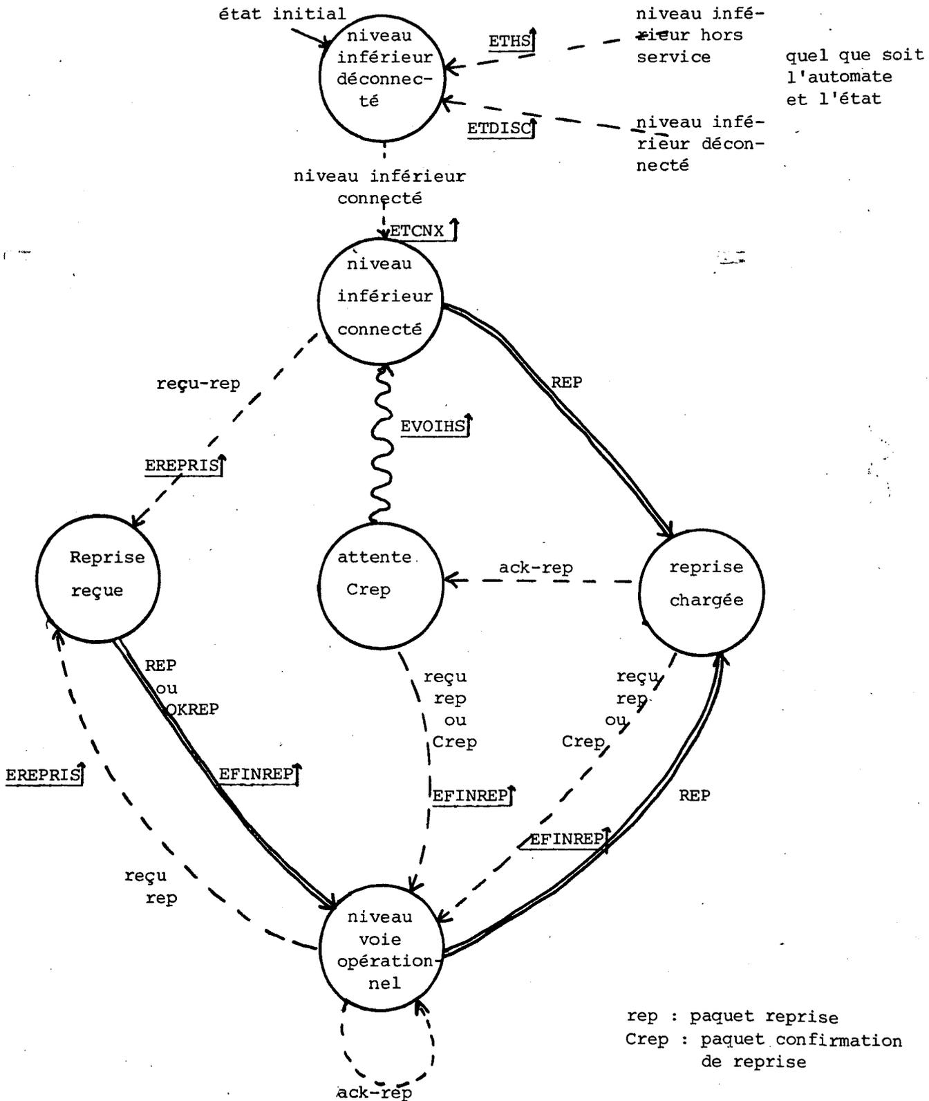
Figure IV.18. - AUTOMATE SIGNALISATION : ETABLISSEMENT ET LIBERATION.
