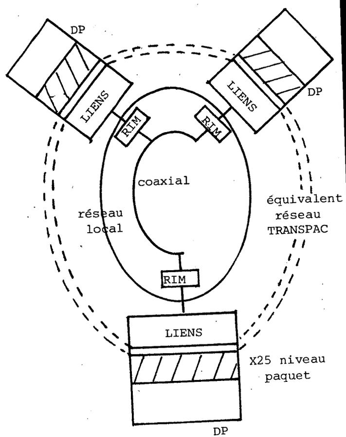
Figure II.6. - Différents niveaux des circuits virtuels internes.
