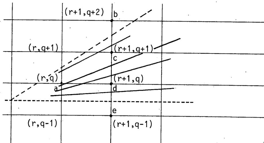
Figure 4 : Différents cas de figure possibles de la situation du point  $a(r, q)$  par rapport au segment théorique.
