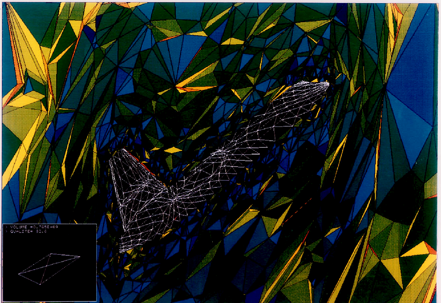
> DARIUS: Maillage de l'exterieur du Falcon avec une couche limite epaisse.
