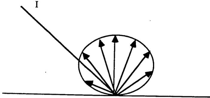
Figure 3.2 : Réflexion sur un matériau rugueux
