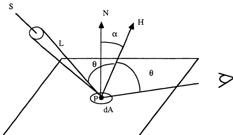
Figure 3.3 : Réflexion de la lumière sur une surface
