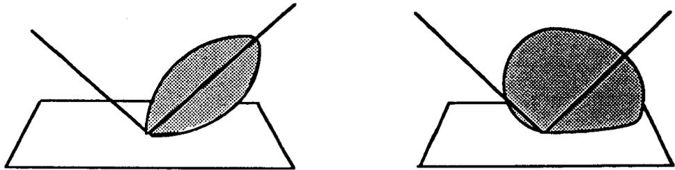
Figure 3.4 : Fonction de distribution de Beckmann pour  $m=0.2$  et  $m=0.6$
