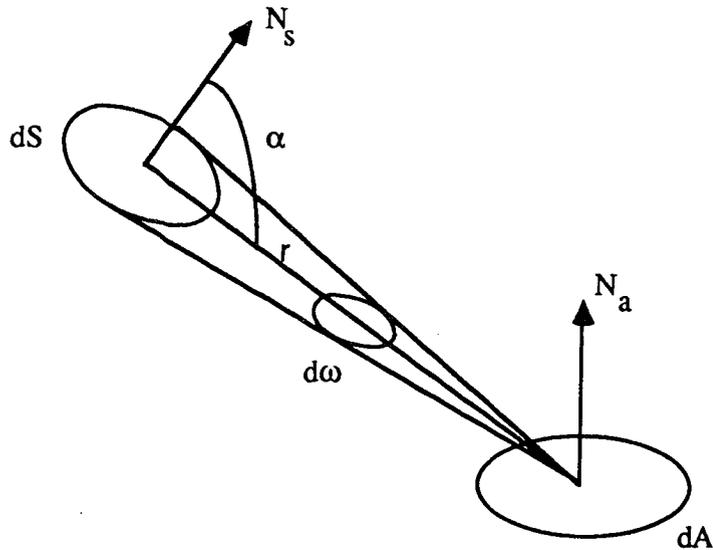
Figure 1.5 : Modèle d'illumination
