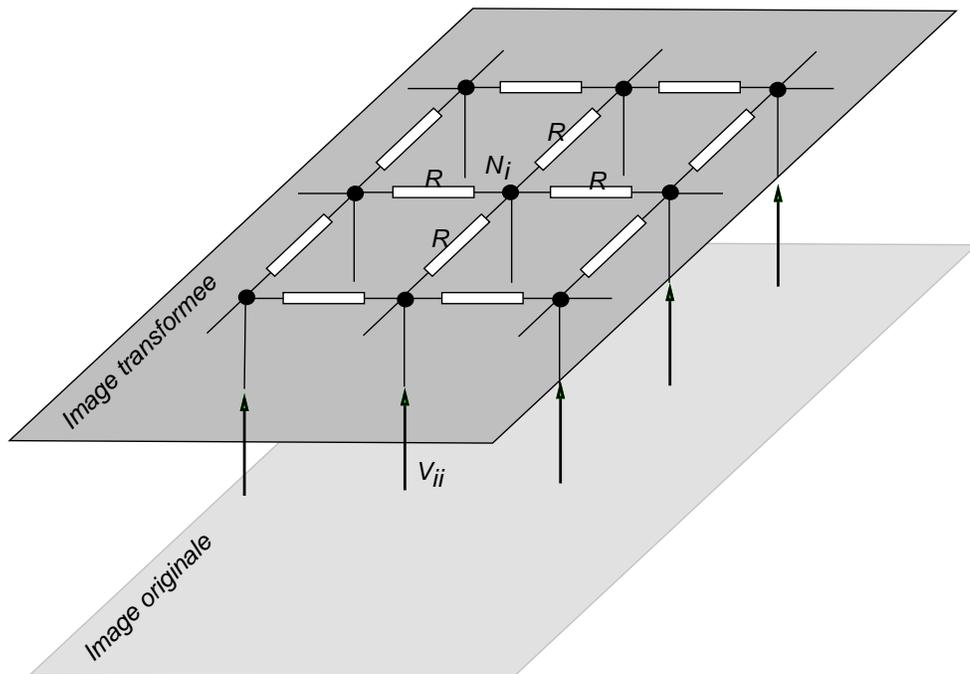
Figure 3.2 : Application de l'analogie électrique à l'image
