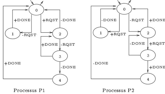
FIG. 1 - Automates associés au protocole de l'exemple 1.
