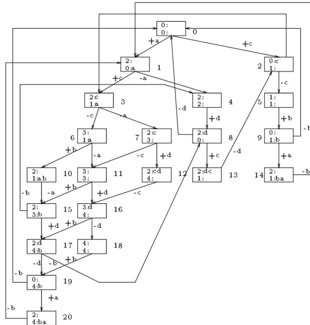
FIG. 11 - Graphe d'accessibilité du protocole de l'exemple 3.
