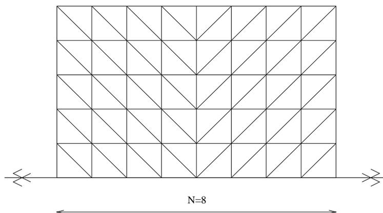
FIG. 4 - *Maillage-type employé pour les éléments MODULEF*
