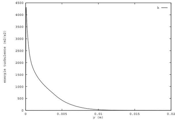
Figure 15 – Profil de l'énergie cinétique turbulente en entrée
