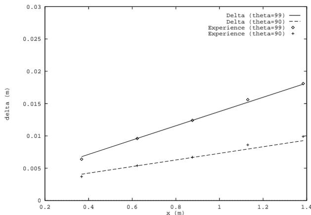
Figure 6 – *Epaisseur de la couche limite turbulente*
