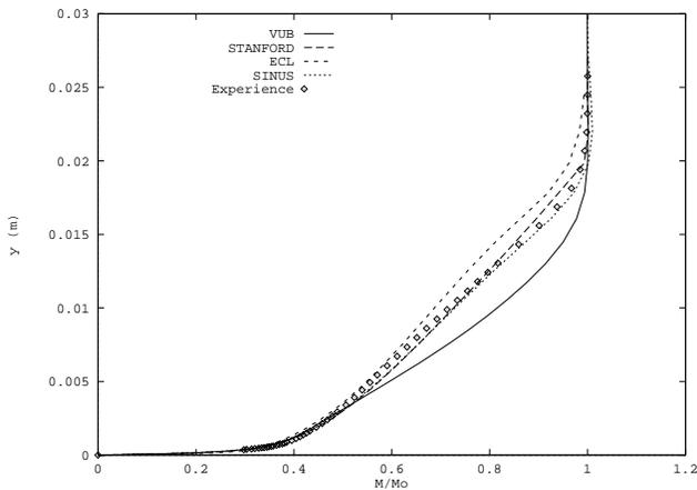
Figure 70 – *Plaque de Mabeys: comparaison des résultats numériques obtenus avec le modèle bicouche et ceux du Workshop ETMA pour le Mach adimensionné en  $x = 1.384$*
