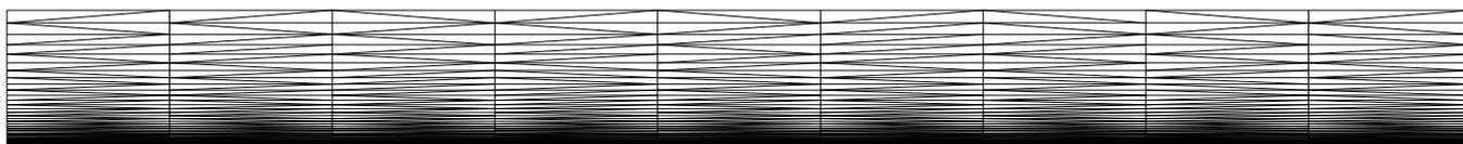
Figure 20 – Maillage structuré de la conduite :  $10 \times 60$  points
