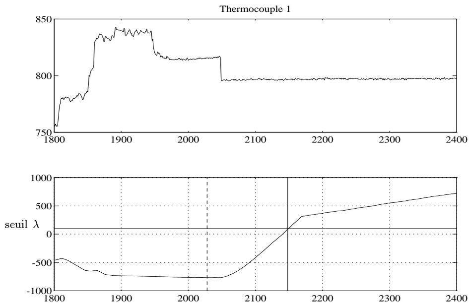
FIG. 12 – *Détection d'une baisse anormale de température de 20 K dans le premier thermocouple à l'instant 2050 - Noter que l'amplitude de ce changement est faible par rapport aux non-stationnarités, et que la statistique de test (traitement séquentiel et multi-capteurs) reste bien négative avant la chute de température.*
