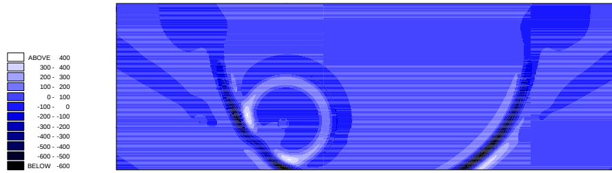
FIG. 12: Instantané avec conditions absorbantes aux bords
