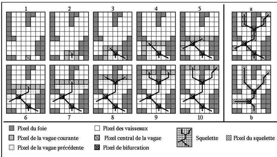
FIG. 12 – *A gauche, méthode par croissance de région sur une image 2D. Chaque schéma représente une itération de la méthode. A droite, comparaison entre le résultat obtenu (a) à celui d'une squelettisation (b). On remarque que la détection des points de bifurcation est imprécise ou erronée.*
