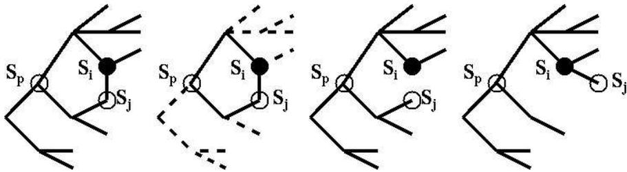
FIG. 19 – Exemple de boucle repérée dans le graphe (à gauche). On note l'origine de la boucle au niveau du sommet  $S_p$  et on retire la dernière branche créant le plus long chemin (deux schémas de droite). On notera dans ce cas de figure que la profondeur d'un des sommet du graphe peut être modifiée.
