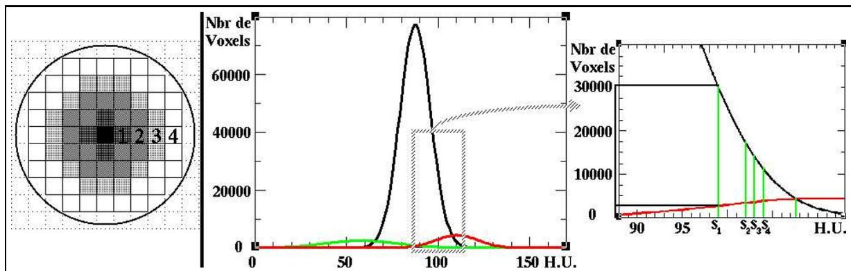
FIG. 8 – *A gauche, définition de l'élément structurant. Les niveaux de gris allant de 1 à 4, indiquent les 4 distances définies sur l'élément structurant. A droite, visualisation des seuils  $s_1$  à  $s_4$  sur le zoom (à droite) des 3 répartitions d'intensités estimées (au centre). On notera au niveau du seuil  $s_1$ , le rapport 12 entre les deux répartitions.*
