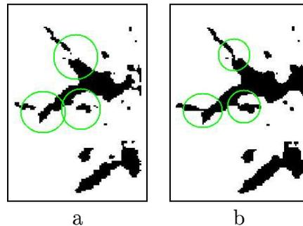
FIG. 9 – *Comparaison entre le seuillage initial (a), et le résultat de notre méthode (b), sur une coupe de l'image. On remarque que les zones entourées que l'on souhaitait récupérer, ont été connectés par notre méthode (b) sans ajout d'erreur de connexion.*
