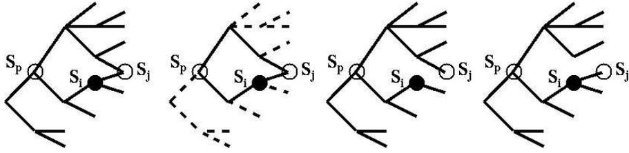
FIG. 18 – Exemple de boucle repérée dans le graphe (à gauche). On note l'origine de la boucle au niveau du sommet  $S_p$  et on retire la dernière branche créant le plus long chemin (deux schémas de droite).
