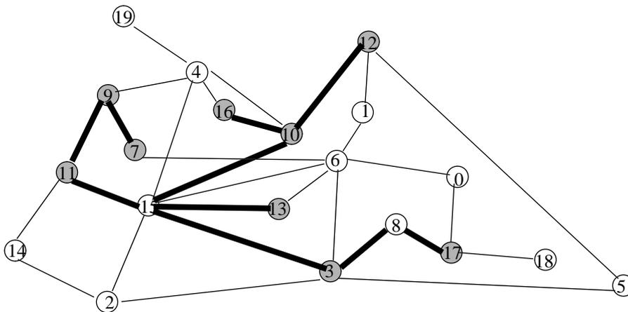
**Figure 14 :** Arbre de Steiner : 10 arêtes
