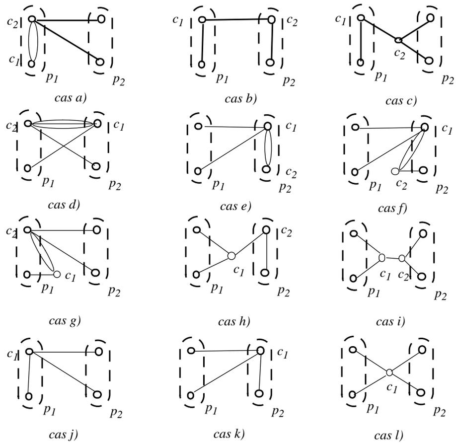
**Figure 15 :** Topologies correspondant aux différents cas particuliers des arbres de Steiner de quatre noeuds
