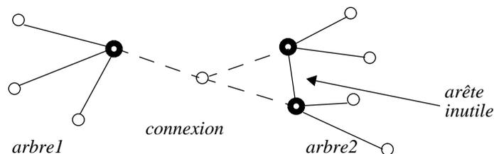
**Figure 10 :** Connexion basée sur trois noeuds
