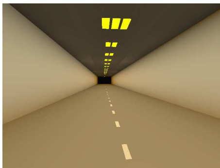
FIG. 17 – Image de tunnel: sources de type Sodium Basse pression
