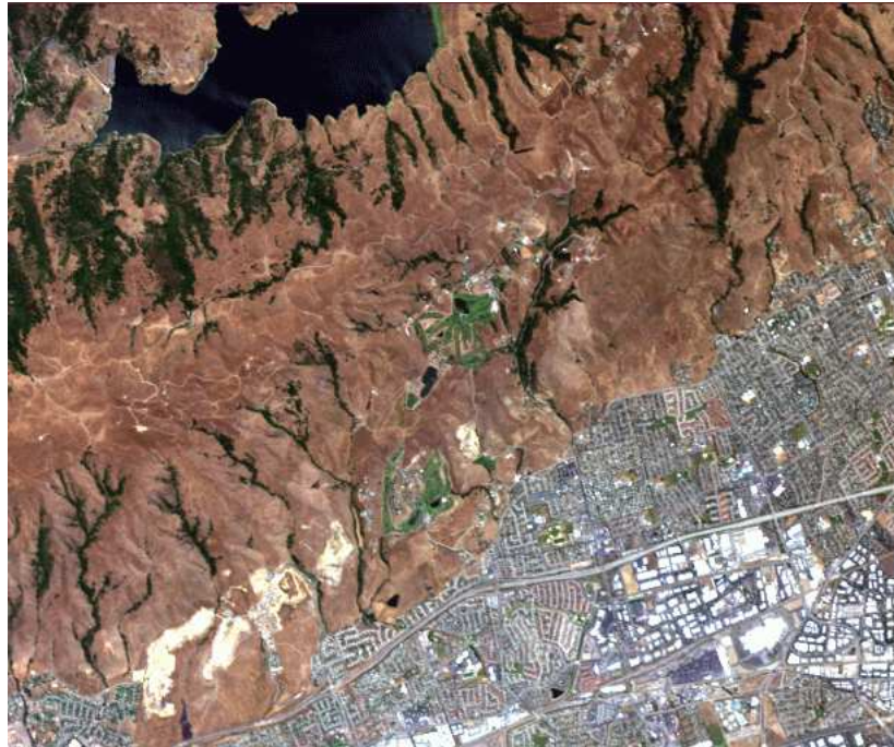
FIG. 8 – Affichage en fausse couleur des canaux \{30,20,10\} d’une scène AVIRIS prise au-dessus de Moffett Field en Californie.
