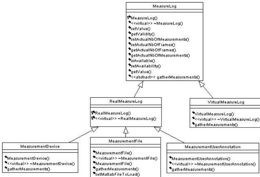
FIG. 24 – Hiérarchie des classes utilisées pour les mesures.
