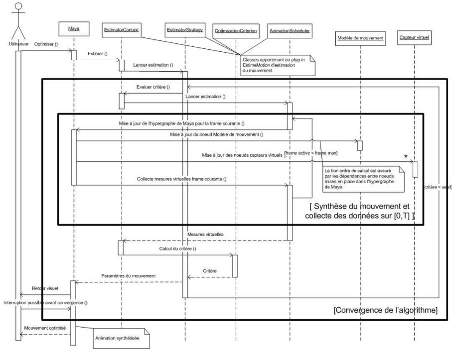
FIG. 13 – Diagramme de séquence détaillant le processus d'estimation.
