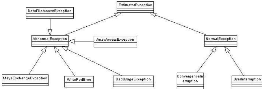
FIG. 14 – Diagramme de classe des conditions d'exception.
