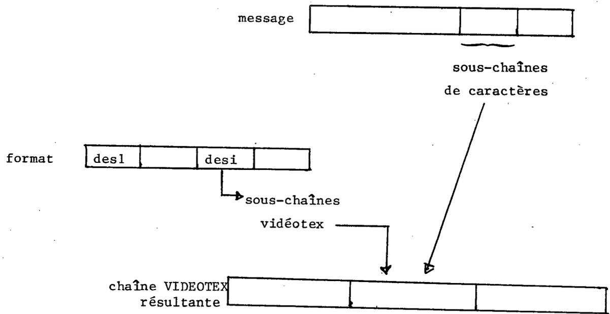
Figure n° 3 : Interprétation d'un descripteur.
