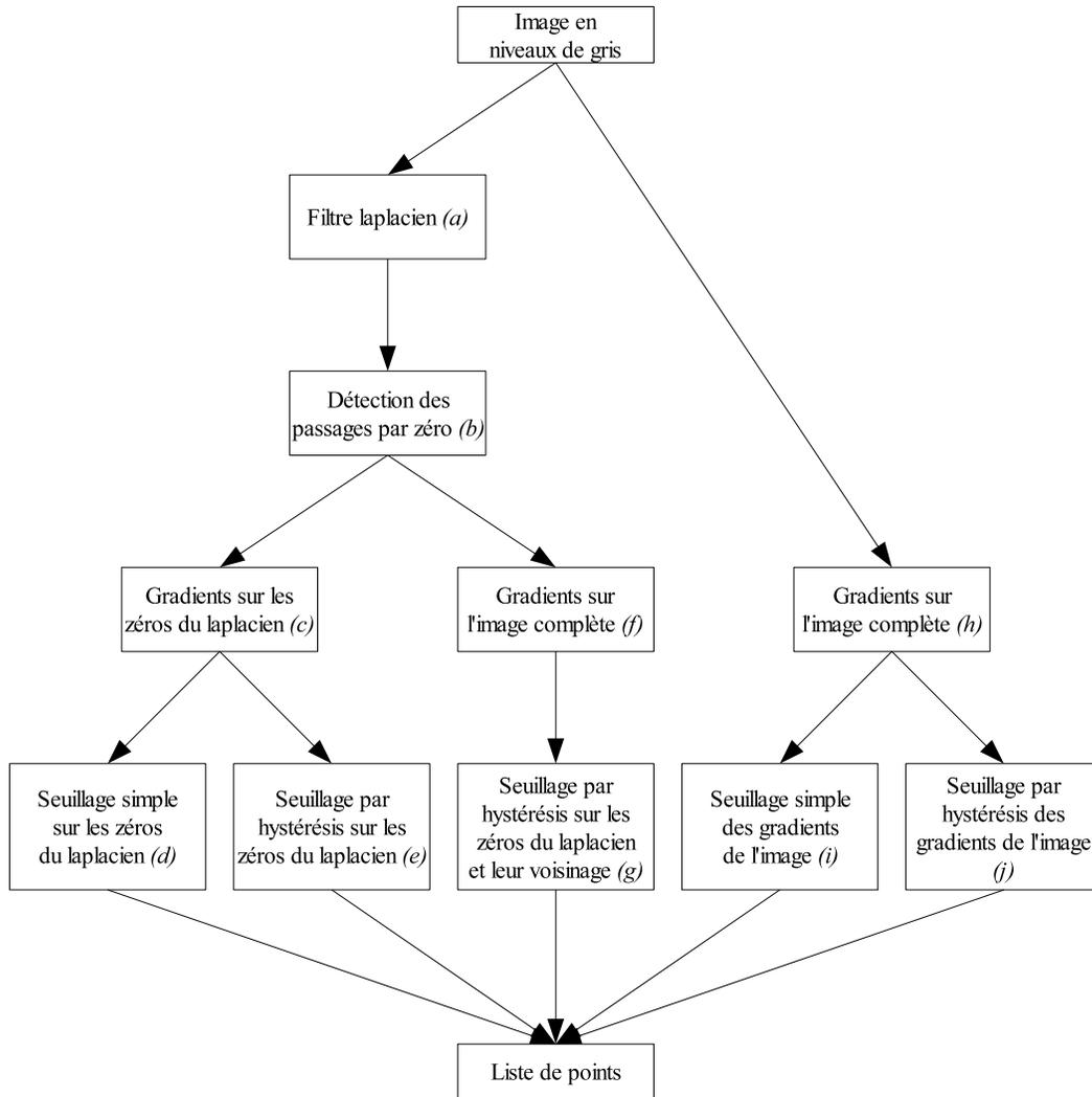
FIG. 10 – Procédures possibles pour la détection des contours
