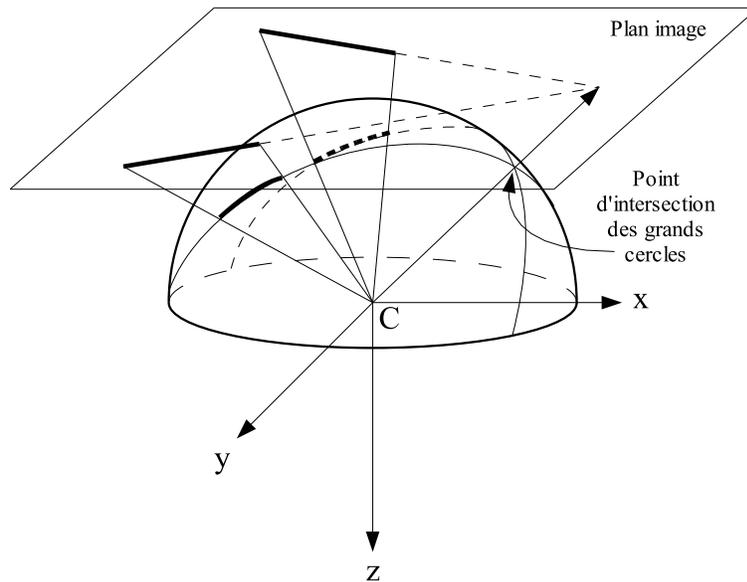
FIG. 16 – Détection d'un point de fuite
