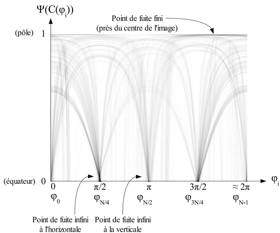
FIG. 19 – Résultat de la transformée de Hough sur hémisphère gaussienne pour 2164 droites transformées sur une grille de 800 cases pour  $\varphi$  et 600 cases pour  $\theta$ . Plus les points sont foncés, plus leur valeur est élevée.
