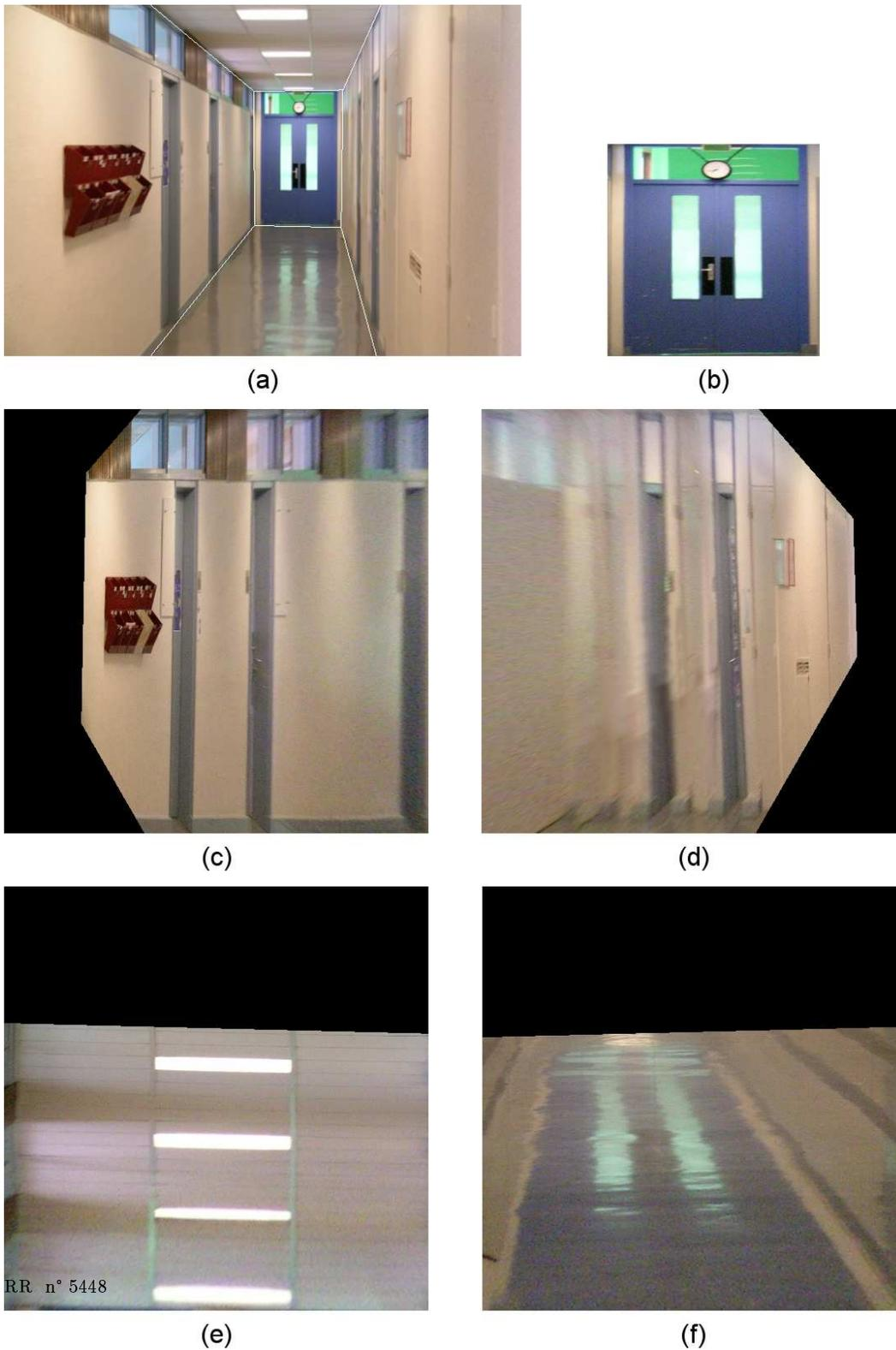
FIG. 28 – Textures calculées pour la scène du couloir ((a) image originale avec affichage des bordures des quadrilatères, (b) texture du fond ( $512 \times 512$ ), (c) texture du mur gauche ( $1024 \times 1024$ ), (d) texture du mur droit ( $1024 \times 1024$ ), (e) texture du plafond ( $1024 \times 1024$ ), (f) texture du sol ( $1024 \times 1024$ ))
