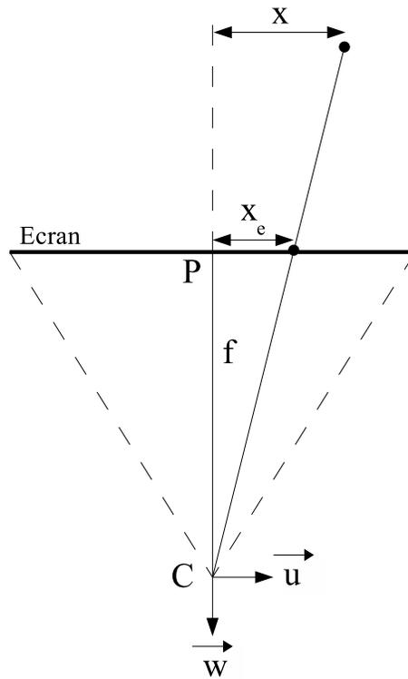
FIG. 8 – Projection perspective d'un point sur l'écran
