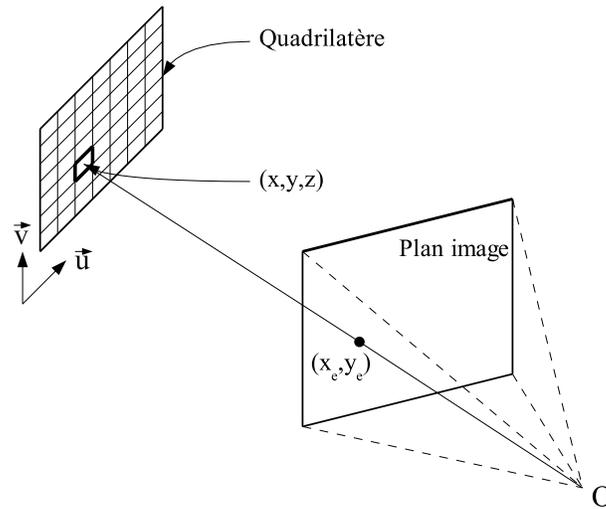
FIG. 30 – Projection d'un texel de coordonnées  $(u, v)$  sur l'image originale pour en déterminer la couleur.  $(x, y, z)$  est la coordonnées dans l'espace du texel,  $(x_e, y_e)$  sa projection sur l'image
