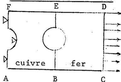
La pièce de la figure ci-dessus est encastree sur la frontière AF et tirée sur la frontière CD. Elle est composée de deux matériaux et a un trou circulaire.
