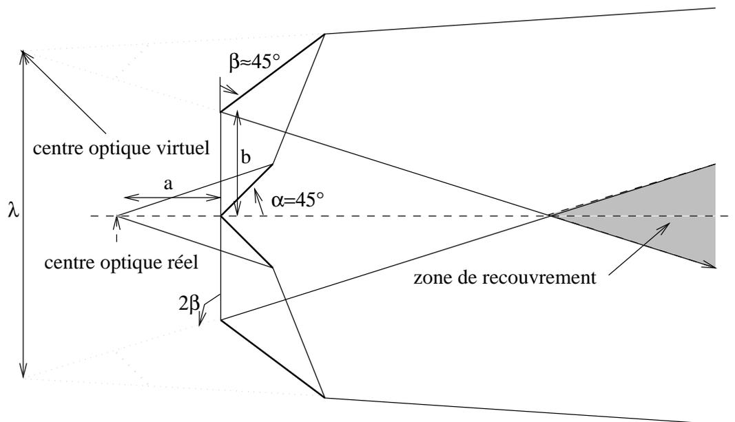
FIG. 1 - Principe géométrique du système de miroirs
