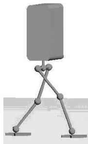
Robot en phase de double support pied droit en avant
