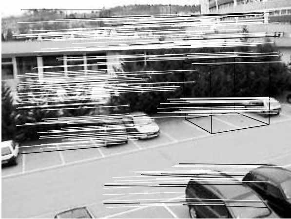
FIG. 9 – Résultats obtenus en temps réel sur une séquence en extérieur. En haut : image 486 augmentée avec un cube virtuel. En bas : image 488 et les appariements lors du mouvement brusque sur la droite.
