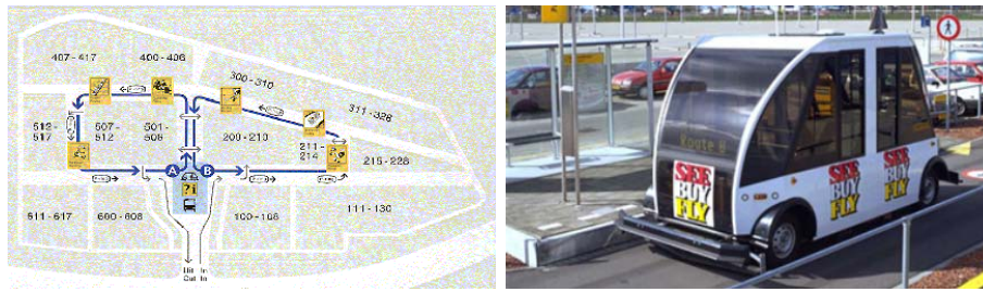
FIG. 3 – Le système Parkshuttle du parking P3 de l’aéroport Amsterdam-Schiphol [depuis décembre 1997].
